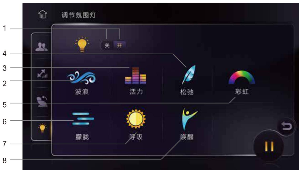
1. 调节氛围灯1: 点击打开开档位, 开机默认为波浪灯光, 灯光在不同自动程序显示不同的效果。
